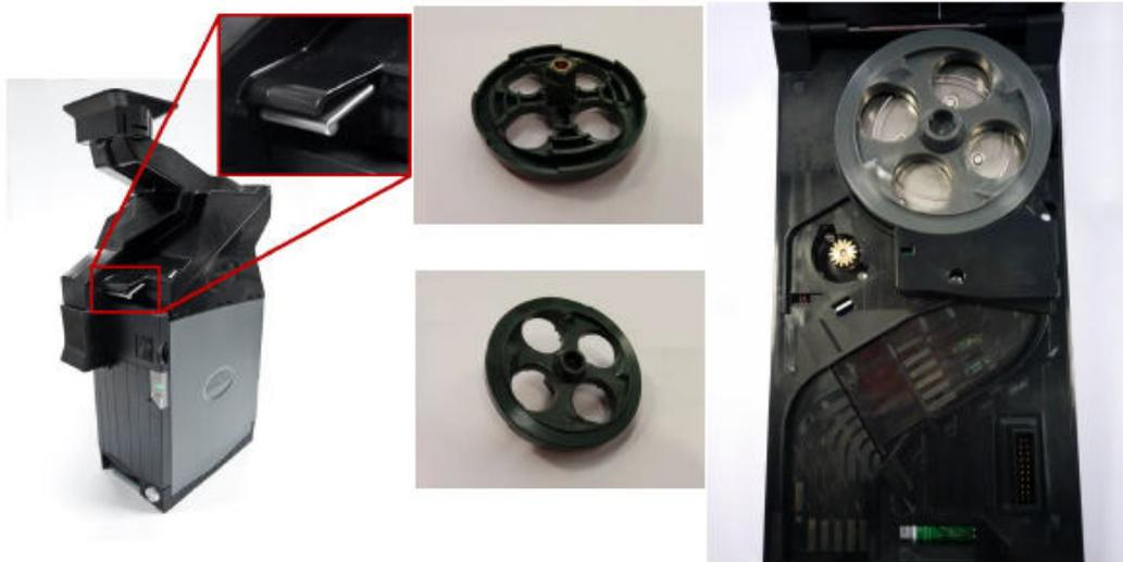
Tras retirar y limpiar el disco, el tornillo requerirá un poco de pegamento en la punta. El par necesario es de 0.60N/m +-5%
