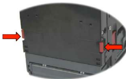
Figura 5: Apertura de la compuerta del Note Float
