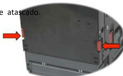
Figura 5: Apertura de la compuerta del Note Float
