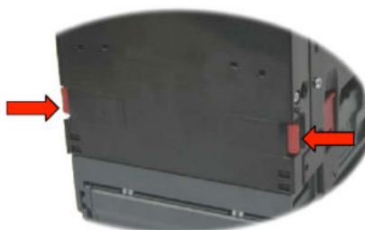
Figura 5: Apertura de la compuerta del Note Float
