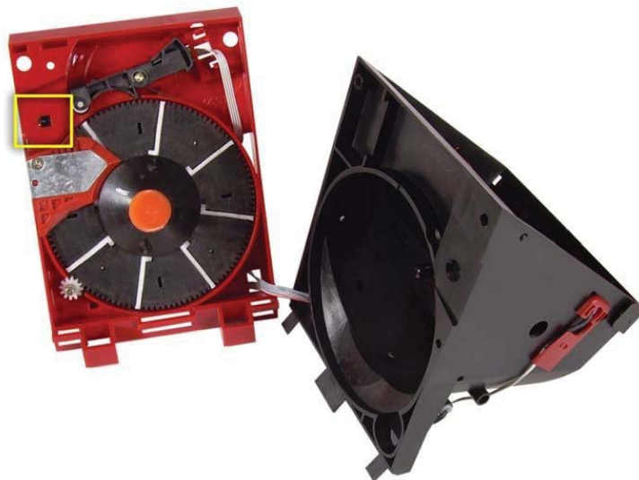
Figura 27. Limpieza Hopper U-II
