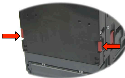
Figura 5: Apertura de la compuerta del Note Float
