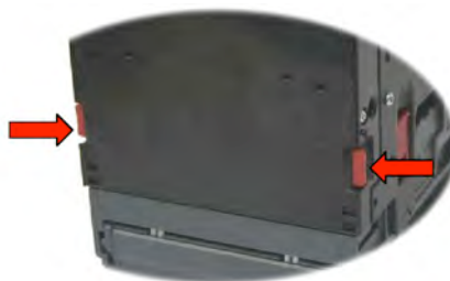
Figura 5: Apertura de la compuerta del Note Float
