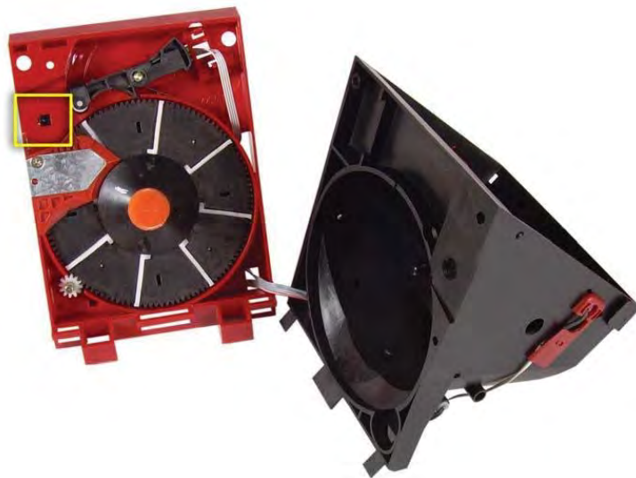
Figura 27. Limpieza Hopper U-II
